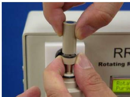
図 4-2. シャフト部分のピーク製ストッパーを指で抑え、RRDE 電極を反時計回しすると、RRDE 電極を取り外すことができます。
