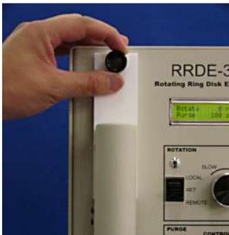
図 12-2. RRDE-3A 本体のモーター固定板を上部に移動し、ノブを固定します。
