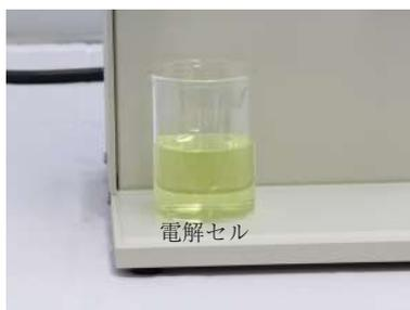
図 5-1. 電解ガラスセルをシリコンシートの上に置きます。サンプルはピペットを用いて簡単に注入できます。
