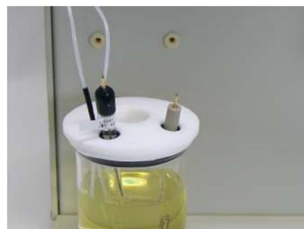
図 8-10 パーズ用チューブと電極をセットした状態
