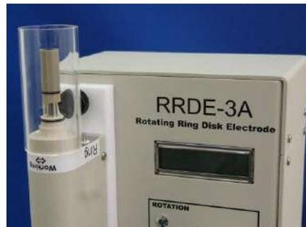
図 12-6. スピンコートを行う準備が整った状態です。電極表面にピペットなどを用いて塗布したいサンプルを滴下し、電極を回転させます。一定速度で電極を数分間回転しますと、膜厚が一定な電極を作ることができます。
