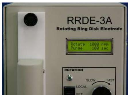
図 8-7. PURGE スイッチを REMOTE にしますと、電気化学アナライザーからスタート信号が入力され、一定時間のパーズが開始されます。
