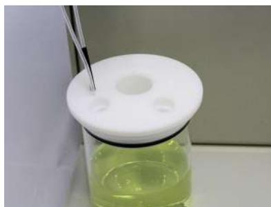
図 8-9 パーズ用テフロンチューブをテフロンキャップの穴に通します。
