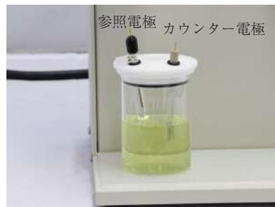
図 5-3. 電極の取り付け方法:テフロンキャップにカウンター電極、参照電極を挿入します。電解の位置はモーター位置固定ノブにより最適な箇所固定します。
