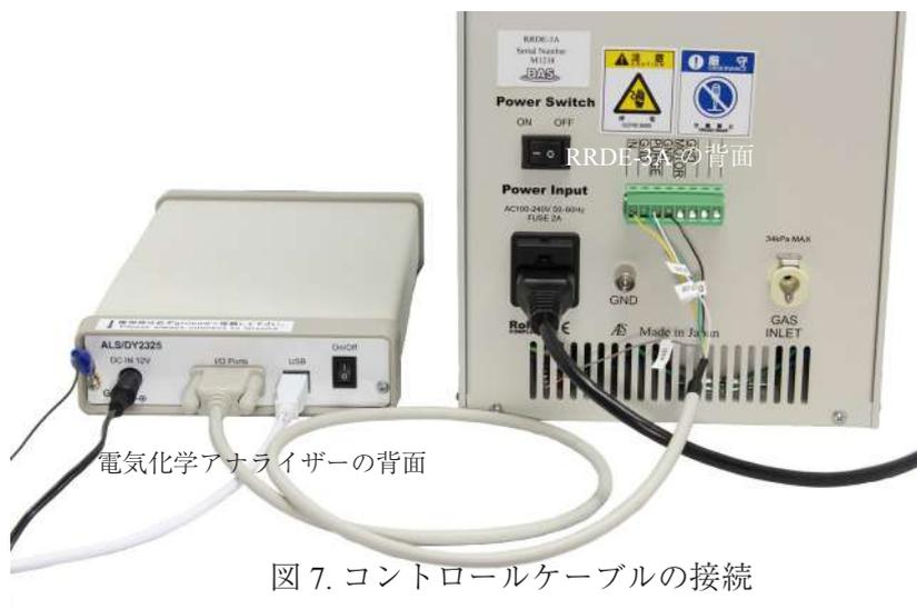
図 7. コントロールケーブルの接続
