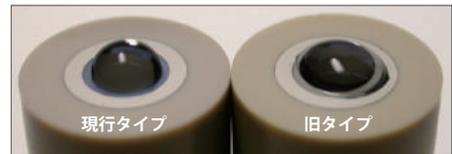
旧タイプのリングディスク電極では、ディスク電極へ修飾する際、注意しないとリング電極まで広がってしまうことがありました。製造方法の見直しにより、従来の電極よりもディスク電極部分への触媒の塗布がしやすくなりました。新しい電極では、滴下した液体がリング電極部分まで広がらずにディスク電極上に留まります。
