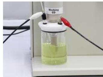
図 6-3. モーターシャフトを下に移動し、作用電極をサンプル溶液に浸漬させます。
