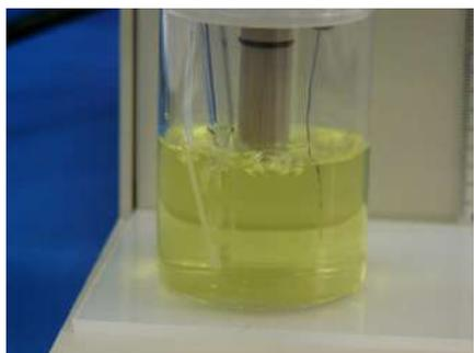
図 8-4. 電解セル中でガスパージを行い、サンプル中の溶存酸素を除去します。
