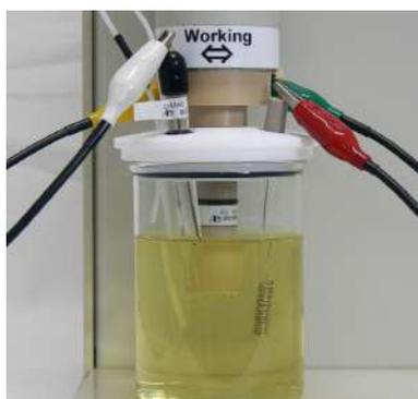
図 9-1 銀 / 塩化銀参照電極、カウンター電極、ガスパーズチューブをセットします。
