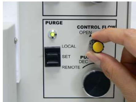
図 8-3. CONTROL FLOW ツマミを回し、パージガス流量を設定します。
