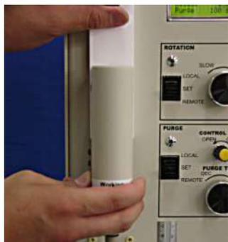
図 12-1. RRDE-3A のモーター位置設定ノブを緩め、テフロンプレートを上方
