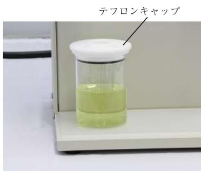
図 5-2. テフロンキャップを電解セルの上に載せます。
