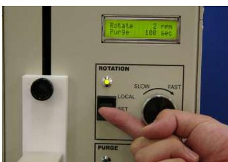
図 10-2. RRDE-3A 本体の回転速度を制御する場合、ROTATION スイッチを "SET" の位置にします。
