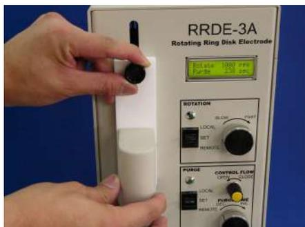
図 4-1. RRDE-3A 本体前面にあるモーターシャフト部分をモーター位置固定ノブを緩め、上に持ち上げます。この時、RRDE 電極がセルホルダーから上にあることを確認します。そして、モーターシャフト部分を斜めにします。
