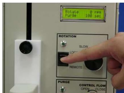
図 9-2 RRDE-3A 本体の PURGE 部は REMOTE 側にスイッチを倒します。
