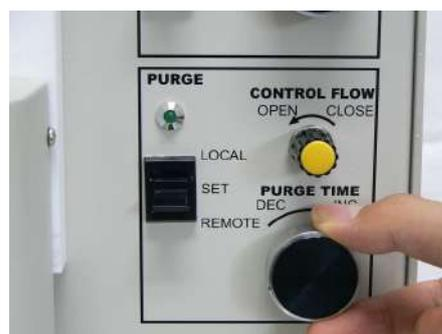
図 8-6. PURGE を REMOTE/LOCAL に SET にしてから、パージ時間で PURGE ツマミを回して必要な時間を設定します。
