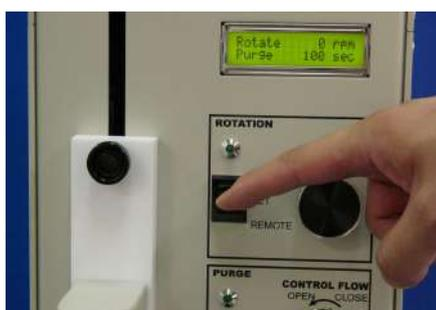
図 10-4. ROTATION スイッチを LOCAL に倒すと電極回転が開始されます。
