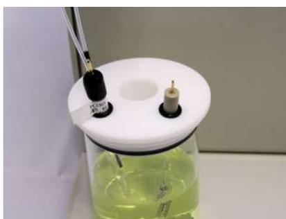
図 8-1. 銀 / 塩化銀参照電極、カウンター電極、ガスパージのチューブをセットします。
