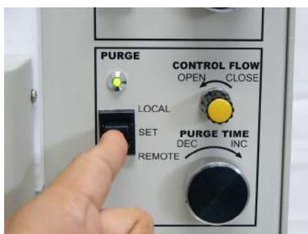
図 8-5. パージを自動制御する場合、PURGE スイッチを REMOTE、マニュアルの場合 LOCAL にします。
