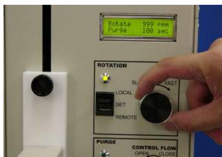
図 10-3. RRDE 電極の回転速度は ROTATION ツマミを回して目的の速度を、例えば 1,000(rpm) に設定します。
