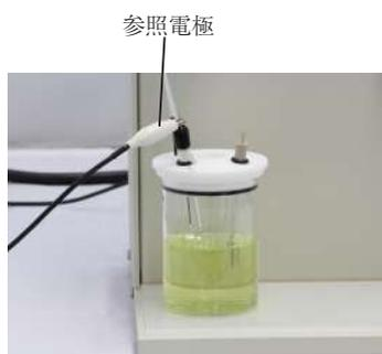
図 6-1. 銀 / 塩化銀参照電極をテフロンキャップに差し込み、白ワニ口クリップを接続します。ガスパージチューブをサンプル液面に差し込みます。
