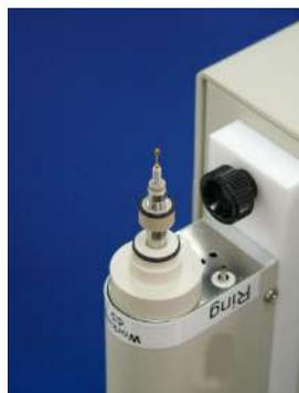
図 12-4. 180° 回転しますと、電極のコンタクトピンが現れます。コンタクトピンは先端が尖っていますので、取扱いに注意して下さい。この先端に RDE、RRDE 電極を取り付けます。
