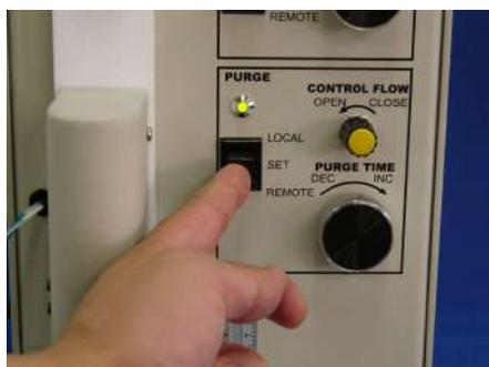
図 8-2. PURGE 部の LOCAL 側にスイッチを倒します。
