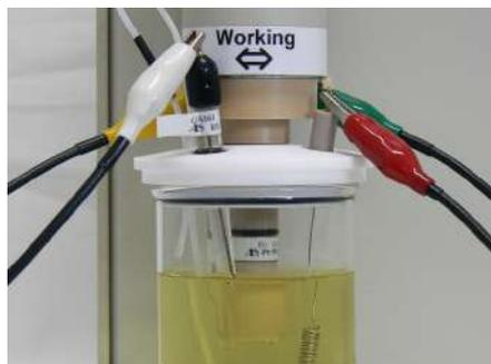
図 10-1. RRDE-3A に電極、サンプル等をセットします。
