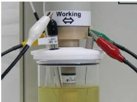
図 11-1. 銀 / 塩化銀参照電極、カウンター電極、ガスバジチューブをセットします。
