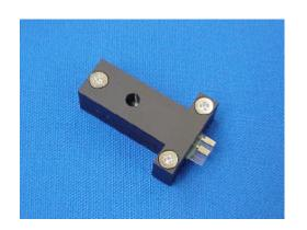
分光電気化学セルを分光セルホルダーに入れ、 電極をポテンショスタットに接続しセットア ップを完了させます。
