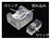
1. セルホルダー(C)の小さい凹みとQCMフローセル(A)側面の切れ込みが同じ向きになるように置き、QCMフローセル(A)とEQCMセル(B)の中心部の穴にシリコンOリング(E)をそれぞれセットします。
