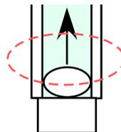
先端のイオン透過性ガラスに触れないようにしてください。
