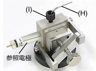
4. ラジアルフローセルブロックに参照電極(別売)、フィッティング(I)、カウンター電極用ステンレスパイプ(H)を取り付けます。
