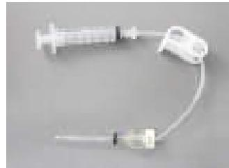
RHE 簡易型可逆水素電極に消耗品キットを左図のように取り付けます。
