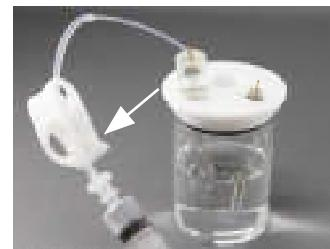
ピンチコックを開いた状態にして、ディスポーザブルシリングを使用して溶液をRHE内へ吸引します。気泡が入らないよう注意して下さい。シリング変換アダプターに溶液が届いたところでピンチコックを締めます。
