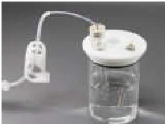
Ptカウンター電極(オプション012961、002233など)を用意し、酸性溶液の入った電解セルにRHEとカウンター電極をセットします。
