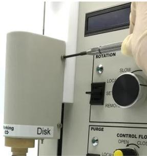
**図 6-10-1.** カバーを固定している 4 本のネジをドライバー(#1 or #2)で外し、カバーを取り外します。
