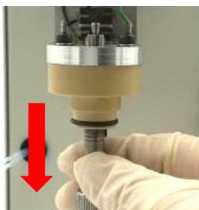
図 6-7-4. シャフトをゆっくり引き抜きます。カーボンブラシに引っ掛かっている場合はカーボンブラシのネジを緩めるか、ピンセットでブラシの板バネを外側に少し曲げます。
