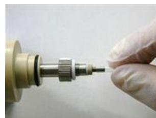
図 6-9-3. 新しい熱収縮チューブをシャフトの先端に取り付けます。
