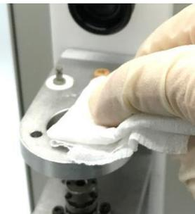
**図 6-10-5.** モーターを 180 度回転させ、アルミフレームの底面をキムワイプや綿棒などで拭きます。
