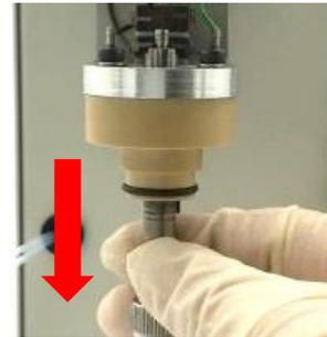
**図 6-10-3.** シャフトをゆっくり引き抜きます。カーボンブラシに引っ掛かっている場合はカーボンブラシのネジを緩めるか、ピンセットでブラシの板バネを外側に少し曲げます。
