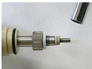
図 6-9-4. シャフトをヒートガンまたはドライヤー(150℃)で包むようにチューブを収縮させます。
