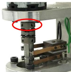
図 6-7-2. カップリングのシャフト固定ネジ(下側 2 本)を、六角レンチ (0.89 mm = 0.035 inch.)で緩めてシャフトの固定を外します。
