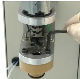
**図 6-10-6.** モーターを元の位置に戻し、新しいベアリングアッセンブリーを慎重に六角レンチで取り付けます。ベアリングアッセンブリーのねじ山は脆いため、ネジを締めすぎないでください。
