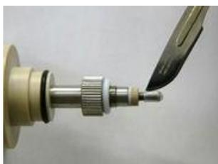
図 6-9-1. プローブを取り出した後、熱収縮チューブをナイフで切断します。
