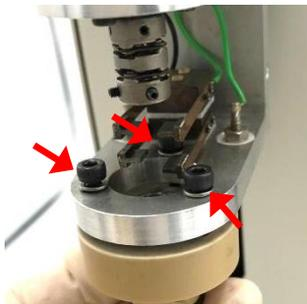
**図 6-10-4.** 六角レンチ(2.5 mm)を用いて、ベアリングを固定している 3 本の六角ネジを取り外します。
