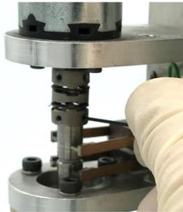
**図 6-10-2.** カップリングのシャフト固定ネジ(下側 2 本)を、六角レンチ (0.89 mm = 0.035 inch.)で緩めてシャフトの固定を外します。
