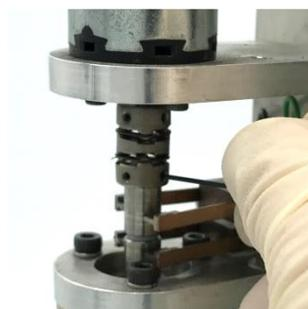
図 6-10-8. カップリング下側のネジ 2 本を六角レンチ (0.89 mm = 0.035 inch) で固定します。その後、カーボンブラシを元に戻します。
