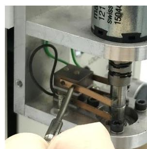
図 6-6-3. 銀カーボンブラシを固定しているネジをドライバー(#000)で取り外します。
