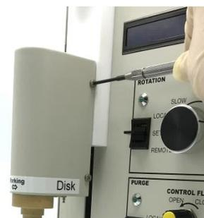
図 6-10-9. カバーをかぶせ、ネジ 4 本をドライバー (#1 or #2) で取り付けます。
