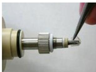
図 6-9-2. 熱収縮チューブを剥離するように取り外します。
