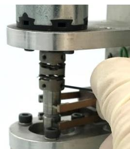
図 6-7-3. シャフトが外れるまで、カップリングの下側の 2 本目のネジを緩めます。シャフトは別の手で保持してください。
