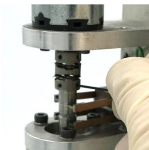
図 6-7-7. カップリング下側のネジ 2 本を六角レンチ (0.89 mm = 0.035 inch) で固定します。その後、カーボンブラシを元に戻します。
