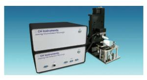
走査型電気化学顕微鏡(SECM)は界面近傍の化学的な変化を高解像度で観察するための装置です。サンプル表面の近傍をスキャンして微小探針で起こる反応を画像化します。SECMは表面の化学物質の反応像、反応速度の定量が可能です。腐食研究、細胞膜の研究、液液界面の研究に用いられています。
