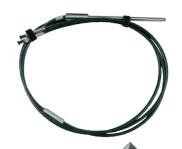
溶液浸漬プローブは 2 分岐しており、それぞれスペクトロメーターと光源に接続します。プローブ部分を溶液に直接浸し、溶液の透過光・吸光度を測定します。D300LM は  $300~\mu m$  ファイバーが 2 本で構成されています。1 本は光照射用、もう 1 本は測定用ファイバーとなります。プローブ先端には光路長チップを取り付けます。光路長別にチップがラインナップされており、2、5、10、20~mm から選択できます。
