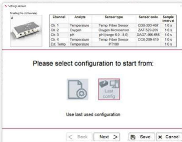
**重要**：それぞれのチャンネルコネクタに接続されているセンサーの正しい**Sensor Code**(センサーコード)を入力してください。センサーコードは、ケーブルに付いているラベル(ファイバーベースのセンサー)、または非接触型センサーの袋に記載されています(右図)。
