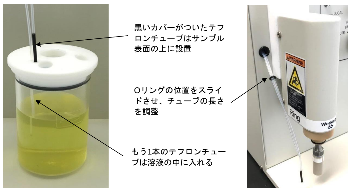
図 3-10-1. テフロンチューブのセット
