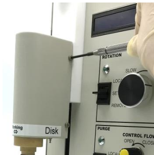
図 6-7-8. カバーをかぶせ、ネジ 4 本をドライバー(#1 or #2)で取り付けます。
