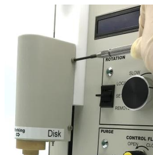
図 6-6-6. モーターシャフトカバーを再度ネジで取り付けます。
