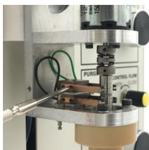
図 6-9-2. 銀カーボンブラシ 4 本を固定しているネジをプラスドライバー(#0)で取り外します。 ネジが小さいため、紛失しないようにご注意ください。
