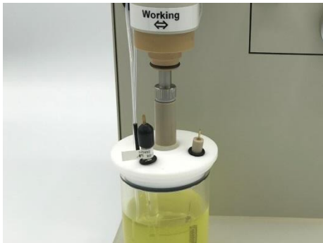
図3-9-4. 作用電極を回転させながら位置設定ノブを緩めてモーターシャフトを下ろし、作用電極を溶液に浸漬させます。
