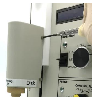
図 6-9-9. カバーをかぶせ、ネジ 4 本をドライバー (#1 or #2) で取り付けます。
