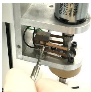
図 6-6-5. 銀カーボンブラシを元に戻します。
