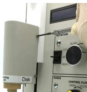
図 6-9-1. カバーを固定している 4 本のネジをドライバー(#1 or #2)で外し、カバーを取り外します。
