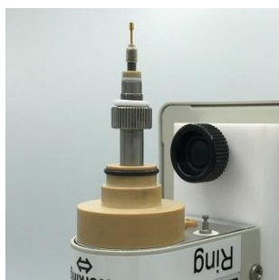
図5-6-4. RDE、RRDE電極を取り付けます。コンタクトプローブは先端が尖っていますので、取り扱いに注意してください。
