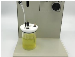
図3-9-3. 参照電極・カウンター電極・パージ用チューブをテフロンキャップに固定します。
