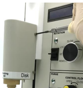
図 6-7-1. カバーを固定している 4 本のネジをドライバー(#1 or #2)で外し、カバーを取り外します。
