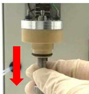
図 6-7-4. シャフトをゆっくり引き抜きます。シャフトが損傷し引き抜くことが難しい場合、ベアリングアッセンブリーと共に取り外してください。
