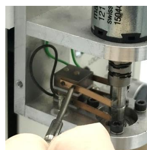
図 6-6-3. 銀カーボンブラシを固定しているネジをドライバー(#0)で取り外します。 ネジが小さいため、紛失しないようにご注意ください。
