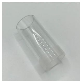
図5-6-5. スピンコートアダプターをセットします。RRDE-3Aの保管時に、シャフト先端のコンタクトプローブの保護にも利用できます。
