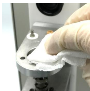
図 6-9-5. モーターを 180 度回転させ、アルミフレームの底面をキムワイプや綿棒などで拭きます。
