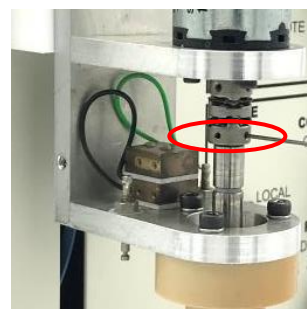
図 6-7-3. カップリングのシャフト固定ネジ(下側 2 本)を、六角レンチ (0.89 mm = 0.035 inch.)で緩めてシャフトを外します。シャフトは別の手で保持してください。間違っても上側ネジも緩めてしまうと位置がずれてしまうのでご注意ください。
