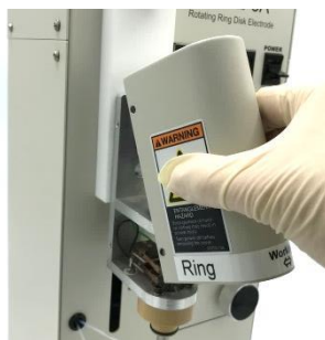
図 6-6-2. モーターシャフトからカバーを取り外します。
