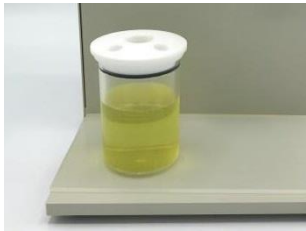
図3-9-2. 電解セルにテフロンキャップをセットします。
