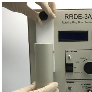
図5-6-1. 位置設定ノブを緩め、テフロンプレートを上方向に移動します。
