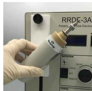
図5-6-3. モーターシャフトを、180°回転します。
