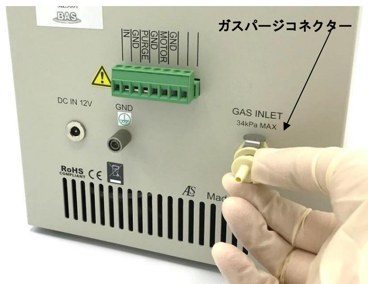
図 3-8-3-1. パージ用ニップルの接続
