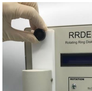
図5-6-2. モーター固定板を上部に移動し、位置設定ノブを固定します。
