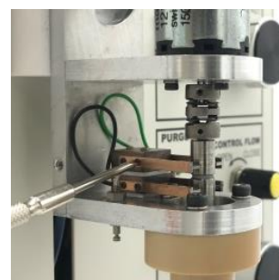
図 6-7-6. 銀カーボンブラシ 4 本をネジで取り付けます。
