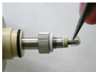
図 6-8-7. 熱収縮チューブを剥離するように取り外します。
