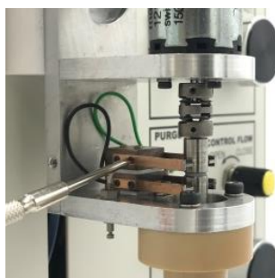
図 6-9-8. 銀カーボンブラシを元に戻します。
