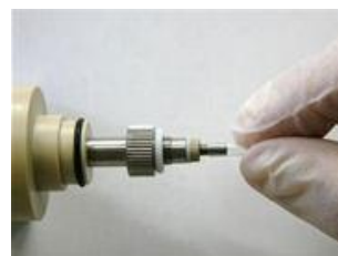
図 6-8-8. 新しい熱収縮チューブをシャフトの先端に取り付けます。
