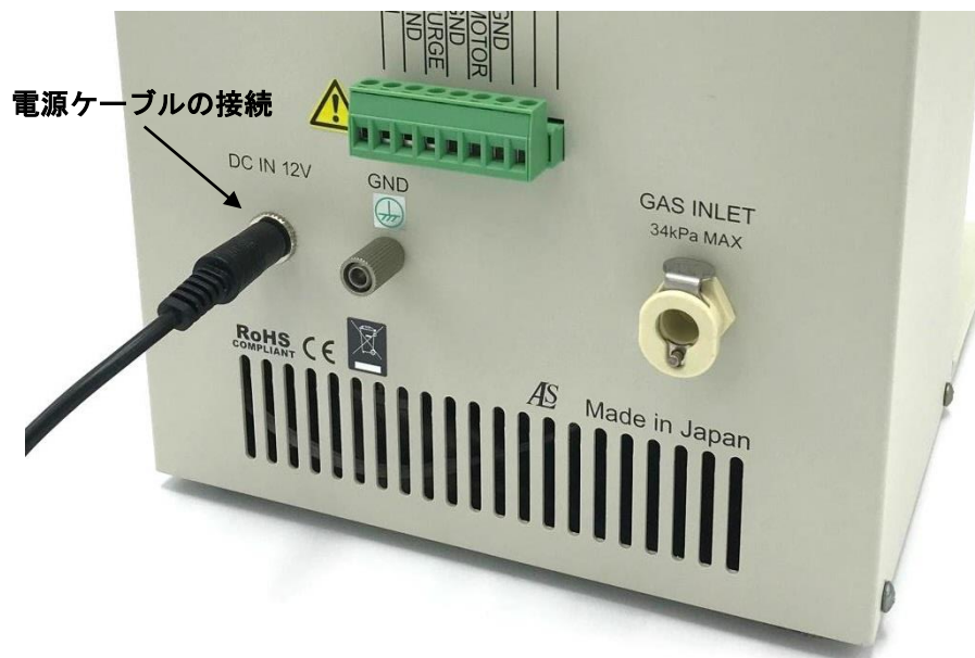
図 3-7-1. 電源ケーブル接続
