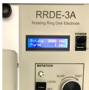
図 6-6-7. 銀カーボンブラシとシャフトの間の抵抗を小さくし、回転中の騒音を低減するために、8000 rpm で10分間回転させてください。
