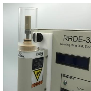
図5-6-6. スピンコートを行う準備が整いました。電極表面にピペット等を用いて塗布したいサンプルを滴下し、電極を回転させます。一定速度で電極を数分間回転すると、膜厚が一定な電極を作ることができます。
