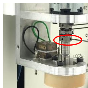
図 6-9-3. カップリングのシャフト固定ネジ(下側 2 本)を、六角レンチ (0.89 mm = 0.035 inch.)で緩めてシャフトを外します。シャフトは別の手で保持してください。 シャフトが損傷し引き抜くことが難しい場合、ベアリングアッセンブリーと共に取り外してください。
