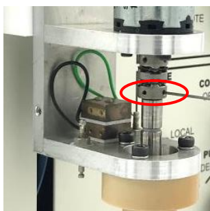
図 6-9-7. 新しいシャフトを取り付けます。カップリング下側のネジ 2 本を六角レンチ (0.89 mm = 0.035 inch) で固定します。
