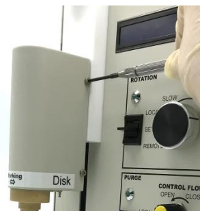
図 6-6-1. RRDE-3A のモーターシャフトカバー側面のネジを、ドライバー(#1 or #2)を用いて外します。
