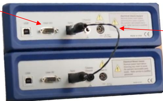
図 A-7-2-3. バイポテンシostat用ケーブルの接続
