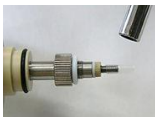
図 6-8-9. シャフトをヒートガンまたはドライヤー(150℃)で包むようにチューブを収縮させます。
