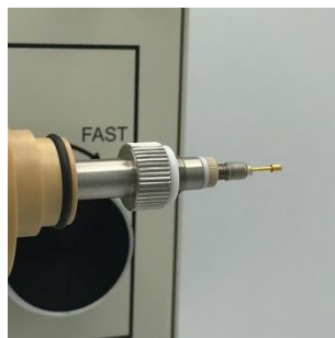
図 6-8-4. 新しいプローブをシャフトに差し込みます。
