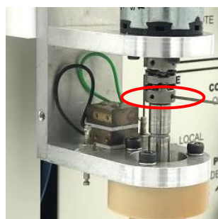
図 6-7-5. 新しいシャフトを取り付けます。カップリング下側のネジ 2 本を六角レンチ(0.89 mm = 0.035 inch)で固定します。
