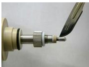
図 6-8-6. プローブを取り出した後、熱収縮チューブをナイフで切断します。
