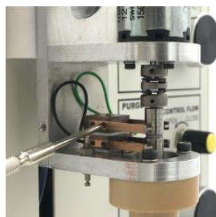
図 6-7-2. 銀カーボンブラシ 4 本を固定しているネジをプラスドライバー(#0)で取り外します。
