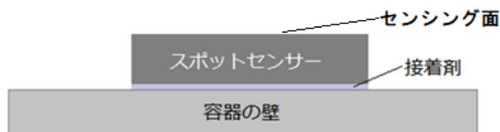
図 12. 理想的に接着された pH スポットセンサーの概略断面図
