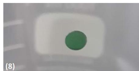
図 13. センサーと容器の内壁の間に気泡がないことを確認する
