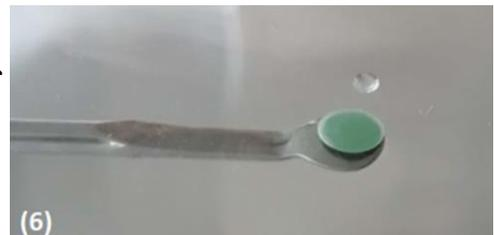
図 9. センサーの裏面を接着剤の滴の上に置く
