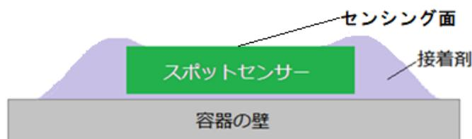
図 11. 理想的に接着された O<sub>2</sub>・温度スポットセンサーの概略断面図
