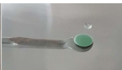
図 2.6 センサーの裏面を接着剤の滴の上に置く
