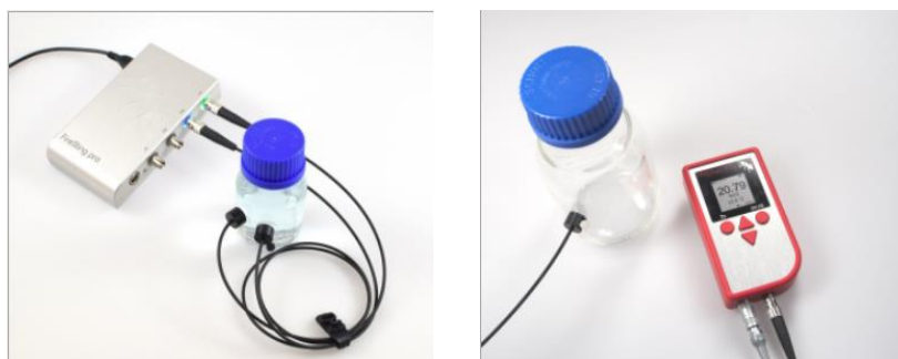
図 4.3 FireSting シリーズ酸素モニターとのセットアップ例
