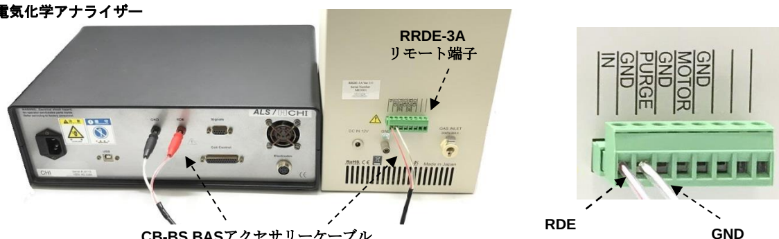
図 13-2-1. RRDE-3A とALS電気化学アナライザーの接続例1
