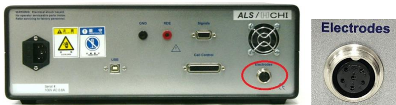
図 3-6-1. セルケーブル端子
