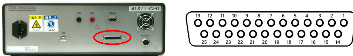
図 3-8-1. セルコントロール端子
