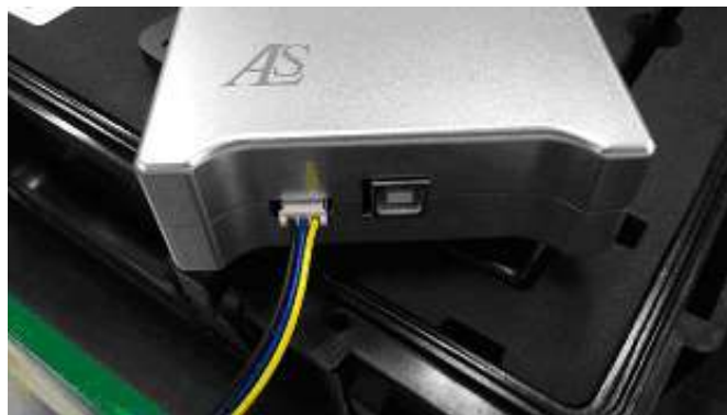
図 A-17-2. Trigger 信号端子の写真。黒色は Ground、黄色は Trigger In 端子
