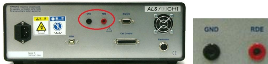
図 3-7-1. RDEコントロール端子
