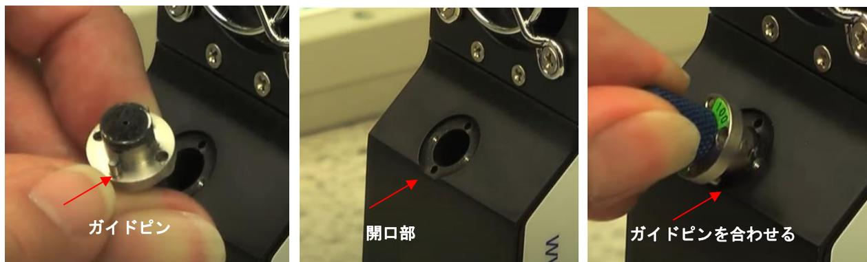
図 2-6 ガイドピンを開口部に合わせて新しいスリットを取り付ける
